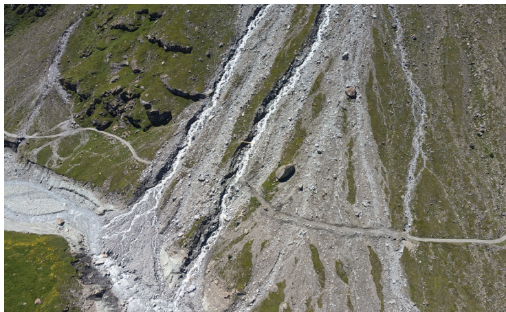
Lave torrentielle de la Tsessette coupant la route communale.
