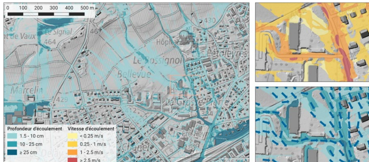
Cartographie des profondeurs et vitesses d'écoulement pour la région de Morges (VD), à une résolution de 1 mètre
